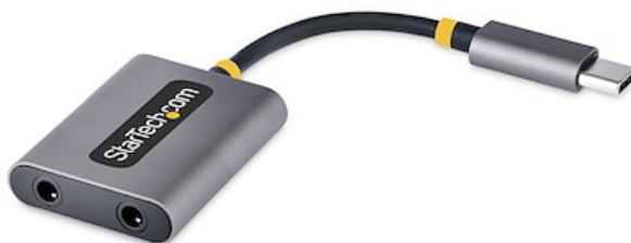
Dieser USB Typ-C Kopfhörersplitter ermöglicht zwei 3,5 mm Audioanschlüsse. Die 3,5 mm Anschlüsse akzeptieren 4-polige 3,5 mm TRRS-Stecker und unterstützen den gleichzeitigen Stereo Audioausgang und Kopfhörer/Mikrofoneingang. Der Adapter hat auch ein integriertes 7 cm USB-C Kabel.
