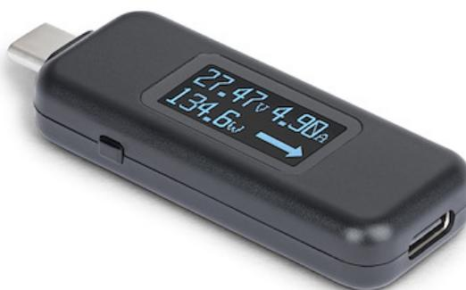
Dieser bidirektionale USB-C-Stromtester ist ein praktisches Werkzeug zur genauen Überwachung von Spannung, Leistung und Stromstärke in jedem USB-C-Stromszenario. Er ist ideal für Techniker und IT-Profis, die überall sofortige, klare Messwerte benötigen. Verwenden Sie diesen Tester, um die zuverlässige Leistung in stromsensiblen Umgebungen zu überwachen und zu erhalten.
