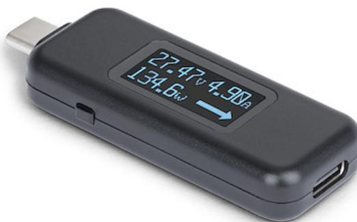
Questo Multimetro Digitale bidirezionale USB-C è uno strumento pratico per monitorare con precisione la tensione, la corrente e la potenza assorbita in qualsiasi circostanza con alimentazione da USB Type-C. È l'ideale per i tecnici e i professionisti IT che desiderano avere letture immediate e chiare ovunque. Utilizzate questo tester per monitorare e mantenere prestazioni affidabili in configurazioni sensibili all'alimentazione.
