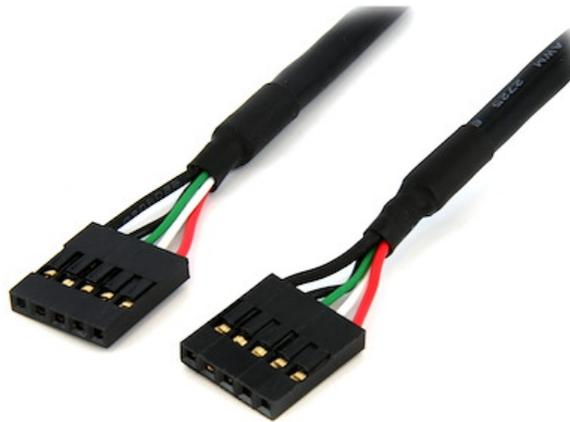
Dieses interne USB-Kabel USBINT5PIN24 verfügt über zwei 5-polige USB-Hauptplatinen-Header-Anschlüsse, sodass Sie einen Frontblenden-USB-Hub oder Kartenleser direkt an Hauptplatinen-Header-Ports anschließen können.
