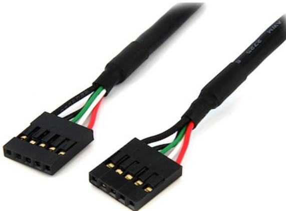
El Cable USB Interno, USBINT5PIN24 dispone de dos conectores USB de 5 pines para cabezal de placa base que permiten conectar directamente un concentrador o lector de tarjeta USB de panel frontal a los puertos del cabezal de placa base.
