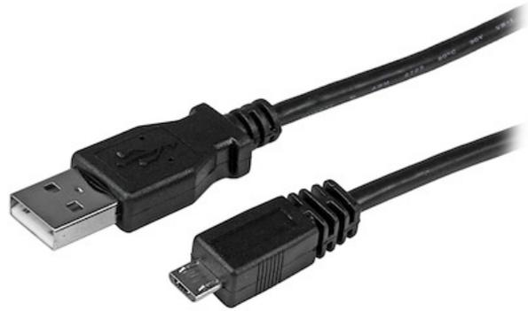
USB 2.0 対応USB A – Micro USBケーブル(2m)。USB Aコネクタ(オス)とMicro Bコネクタ(オス)を各1本備えており、Micro USBコネクタを使用するUSB 2.0対応モバイルデバイス(Android携帯電話、デジタルカメラ、タブレット型PC機器、GPSシステム等)をコンピューターのUSBポートに接続し、データの同期化やファイル送受信など日常的なタスクを行います。
