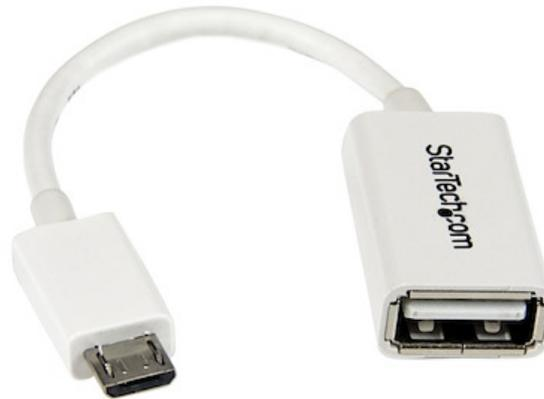
El cable adaptador Micro USB OTG ("On-The-Go", portátil), blanco, modelo UUSBOTGW, convierte el puerto Micro USB de un smartphone o una tableta en puerto USB anfitrión que se puede utilizar para conectar un dispositivo periférico USB, como un ratón, un teclado o una memoria USB.
