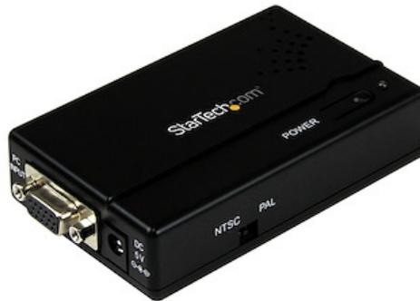
Ce convertisseur haute résolution VGA vers Composite ou S-Video est une solution matériel simple qui vous permet de convertir un signal vidéo VGA/PC en un signal Composite ou S-Video, à des fins d'utilisation avec un moniteur CRT ou un écran plat.
