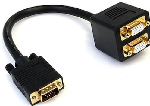
Ce câble répartiteur vidéo VGA de 30 cm vous permet de connecter deux moniteurs VGA à une seule source vidéo VGA. Solution économique pour les configurations à deux écrans VGA.
