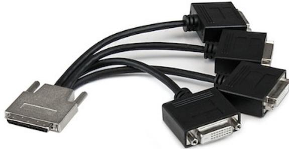
Mit dem VHDCI-auf-Quad-DVI-Splitterkabel VHDCI24DVI können Sie bis zu vier DVI-D-Single Link-Displays an Ihre VHDCI-Videokarte (z. B. NVIDIA® Quadro® NVS™, und VisionTek AMD-Grafikkarten) mit Auflösungen bis zu 1920 x 1200 anschließen.
