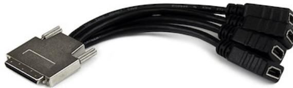
El cable divisor VHDCI a HDMI cuádruple VHDCI24HD le permite conectar un máximo de cuatro pantallas HDMI a su tarjeta gráfica VHDCI (por ejemplo, las tarjetas de gráficos NVIDIA® Quadro® NVS™ y VisionTek AMD) en resoluciones de hasta 1920 x 1200.
