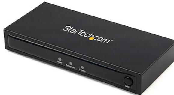
Ce convertisseur S-Video ou composite vers HDMI® avec audio vous permet de connecter un appareil S-Video ou composite analogique, ainsi qu'un son RCA L/R, à votre moniteur ou téléviseur HDMI.
