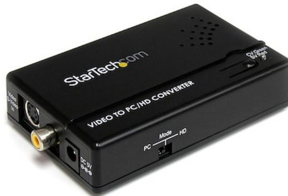
El Conversor de Vídeo Compuesto y S-Vídeo a VGA (con Escalador), VID2VGATV2 proporciona una forma sencilla de convertir las señales de vídeo compuesto o S-Vídeo en una salida VGA (o Componente RCA) para utilizar con monitores de ordenadores, proyectores o televisores de alta definición.
