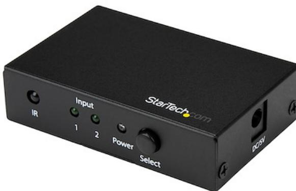
Este conmutador HDMI de 2 puertos le permite compartir una pantalla o proyector HDMI 2.0 con dos fuentes de vídeo HDMI 2.0. El conmutador incluye dos entradas de vídeo independientes compatibles cada una con resolución 4K a 60Hz, lo cual resulta ideal para la conexión de dos fuentes de vídeo a una pantalla con número limitado de puertos HDMI 2.0.
