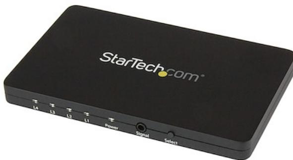
El conmutador HDMI 4K de 4 puertos, modelo VS421HD4K, permite el uso compartido de una pantalla o un proyector con cuatro dispositivos fuente equipados con audio / video HDMI. El conmutador incluye cuatro entradas independientes, cada una de las cuales es compatible con la resolución 4K y el audio de sonido envolvente 7.1.
