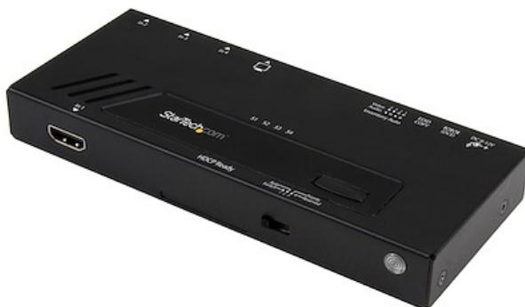
Cree una poderosa experiencia visual, con la capacidad de conmutación continua entre cuatro fuentes de vídeo 4K. Este conmutador HDMI® de 4 puertos le permite compartir un monitor, proyector o TV con cuatro fuentes de vídeo Ultra HD, para cambiar entre ellas sin casi interrupción.
