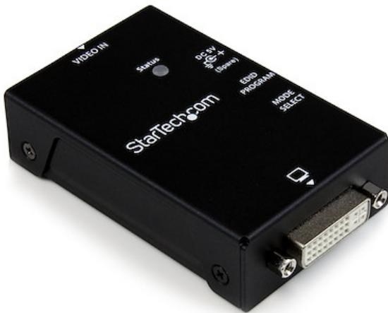
Mit dem DVI EDID-Emulator VSEDIDDV1 können Sie Extended Display Identification Data von einem Monitor erfassen und erhalten. Der Monitor kann dann mit einer Videosignalquelle (Video Extender, KVM-Switch usw.) verbunden werden, um EDID-Informationen weiterzugeben und zu gewährleisten, dass die korrekten Videoeinstellungen erhalten bleiben.
