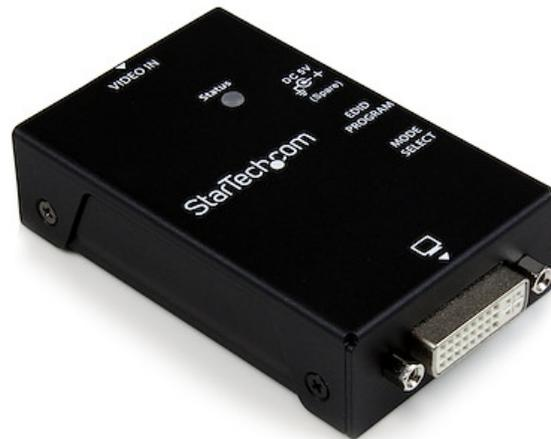
L'émulateur EDID DVI VSEDIDDVI vous permet de capturer et conserver les données « Extended Display Identification Data » d'un moniteur, qui peut alors être connecté à la source du signal vidéo (extendeur vidéo, commutateur KVM, etc.) pour passer les données EDID et garantir que les paramètres vidéo adaptés sont maintenus.
