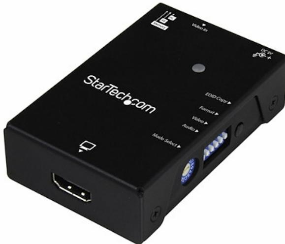
Dieser EDID-Emulator löst Videokommunikationsprobleme, die zwischen HDMI-Videoquelle und Display auftreten können. Der Emulator kann die erweiterten Displaykennungsdaten (EDID) vom HDMI-Display kopieren oder synthetisieren und sie an Ihre Videoquelle weiterleiten, um Probleme zu lösen, die sich aus der Verwendung von Drittanbieter-Geräten, z. B. Video-Extenders, Video-Switches oder KVMs in Ihrer Videokonfiguration ergeben können.
