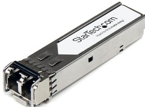
Der XG-SR-ST ist ein Brocade XG-SR-kompatibles Glasfaser SFP+-Transceiver-Modul, das für den Einsatz mit Brocade® Marken-Switches und -Routern entwickelt, programmiert und getestet wurde. Es sorgt für zuverlässige 10 GbE-Konnektivität über Glasfaser-Kabel für 10GBASE-SR-konforme Netzwerke mit einer maximalen Entfernung von bis zu 300m.
