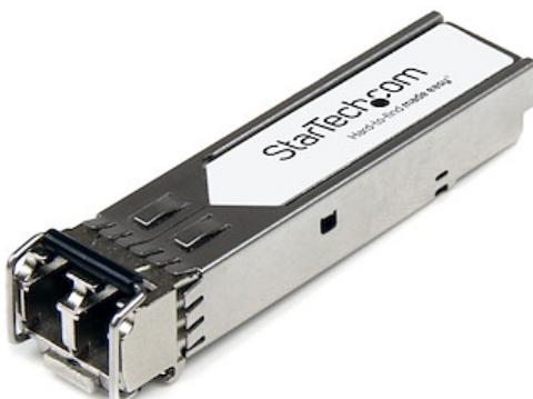
El modelo XG-SR-ST es un módulo transceptor SFP+ por fibra óptica compatible con el modelo XG-SR de Brocade diseñado, programado y probado para su funcionamiento con routers y switches de la marca Brocade®. Ofrece conectividad fiable a 10 GbE, a través de cable de fibra óptica, para redes compatibles con 10GBASE-SR, a una distancia máxima de hasta 300 m.
